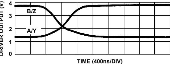
FIGURE 14. DRIVER AND RECEIVER WAVEFORMS, LOW TO HIGH (ISL8483, ISL8488, ISL8489)
