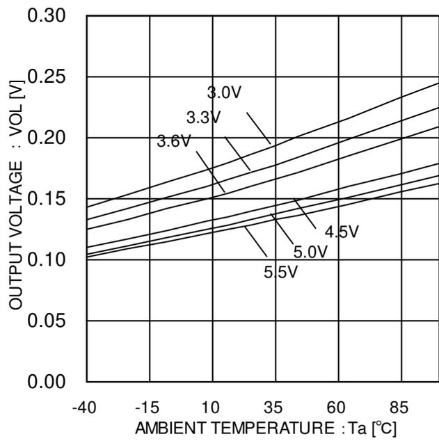
Figure 12. SEROUT low side voltage
