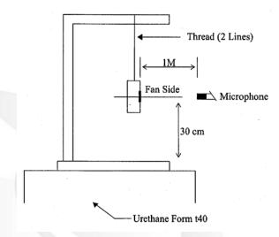
1 METER FROM MICROPHONE TO FAN INTAKE
