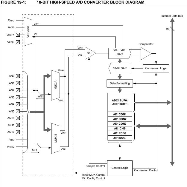
10-BIT HIGH-SPEED A/D CONVERTER BLOCK DIAGRAM
