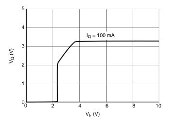
Figure 23. Output Voltage  $V_{\mathsf{Q}}$  vs. Input Voltage  $V_{\mathsf{I}}$
