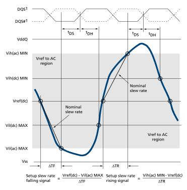
Note: 1. DQS, DQS# signals must be monotonic between Vil(DC) MAX and Vih(DC) MIN.
