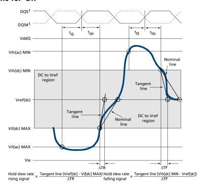
Note: 1. DQS, DQS# signals must be monotonic between Vil(DC) MAX and Vih(DC) MIN.
