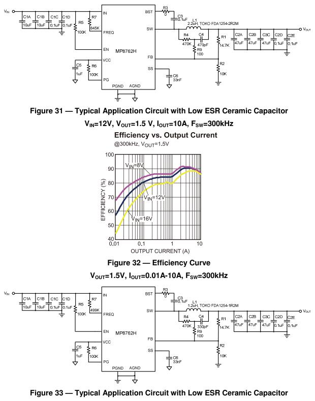
V<sub>IN</sub>=12V, V<sub>OUT</sub>=1.5 V, I<sub>OUT</sub>=10A, F<sub>SW</sub>=500kHz
