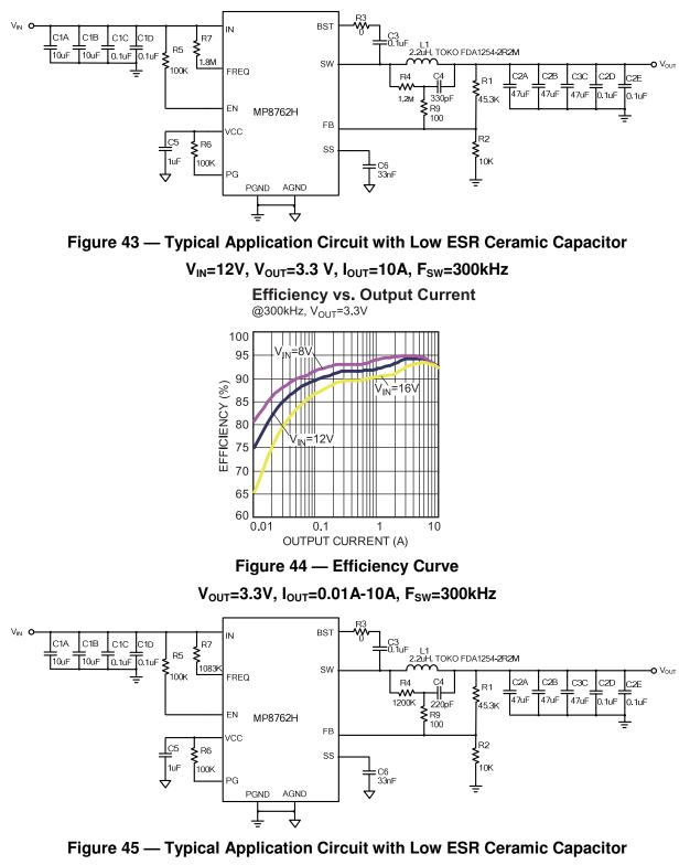
V<sub>IN</sub>=12V, V<sub>OUT</sub>=3.3 V, I<sub>OUT</sub>=10A, F<sub>SW</sub>=500kHz
