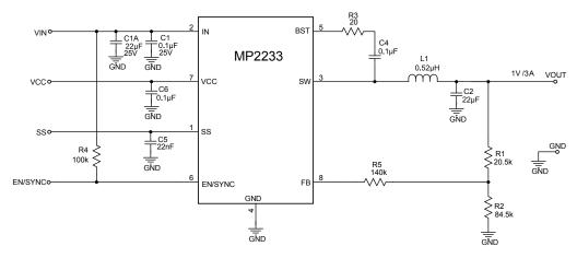
**Figure 12: V**<sub>IN</sub> **= 12V, 1V/3A Output**
