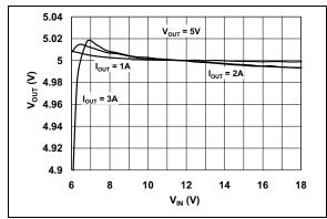
FIGURE 2-13: 5V  $V_{OUT}$  vs.  $V_{IN}$ .
