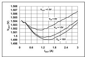
**FIGURE 2-11:** 1.5V V<sub>OUT</sub> vs. I<sub>OUT</sub>.
