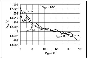
**FIGURE 2-17:** 1.5V V<sub>OUT</sub> vs. V<sub>IN.</sub>
