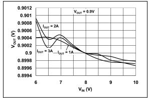
**FIGURE 2-18:** 0.9V V<sub>OUT</sub> vs. V<sub>IN.</sub>
