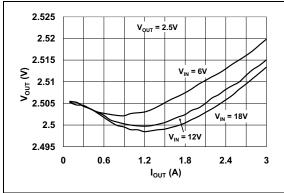
**FIGURE 2-9:** 2.5V V<sub>OUT</sub> vs. I<sub>OUT</sub>.
