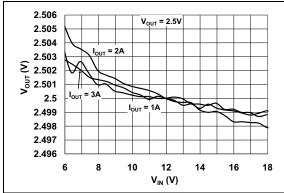
**FIGURE 2-15:** 2.5V V<sub>OUT</sub> vs. V<sub>IN.</sub>
