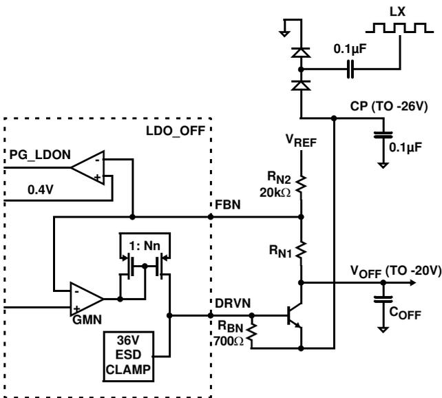
FIGURE 20. V<sub>OFF</sub> FUNCTIONAL BLOCK DIAGRAM
