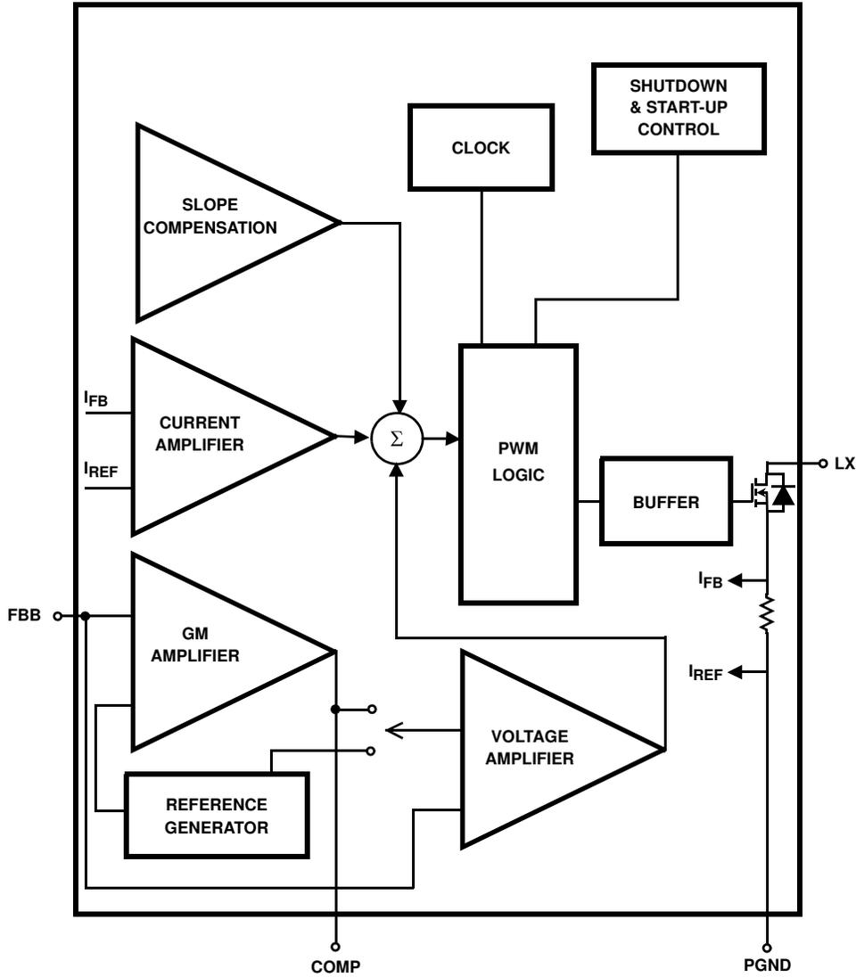
FIGURE 18. THE BLOCK DIAGRAM OF THE BOOST CONTROLLER
