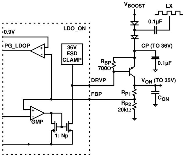
FIGURE 19. V<sub>ON</sub> FUNCTIONAL BLOCK DIAGRAM
