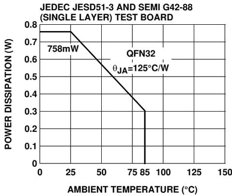
FIGURE 15. PACKAGE POWER DISSIPATION vs AMBIENT TEMPERATURE
