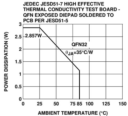
FIGURE 16. PACKAGE POWER DISSIPATION vs AMBIENT TEMPERATURE
