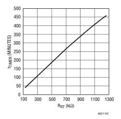
Figure 7. t<sub>TIMER</sub> vs R<sub>RT</sub>
