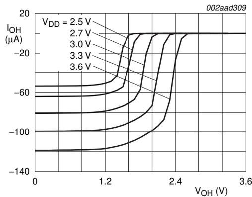
c.  $T_{amb} = 85\text{ }^{\circ}\text{C}$
