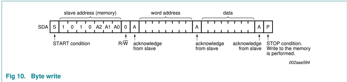
Fig 10. Byte write
