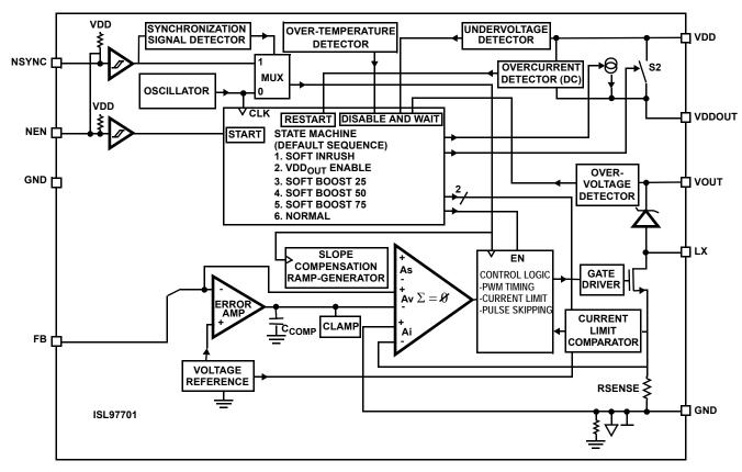
FIGURE 1. ISL97701 BLOCK DIAGRAM
