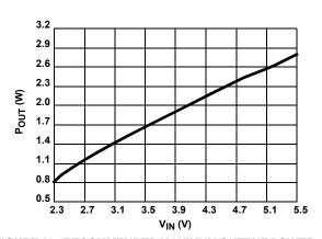
FIGURE 13. RECOMMENDED MAXIMUM OUTPUT POWER vs INPUT VOLTAGE
