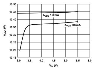
FIGURE 3. LINE REGULATION  $A_{VDD} \mbox{ vs } V_{\rm IN}$
