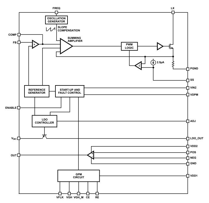
FIGURE 13. ISL97646 BLOCK DIAGRAM
