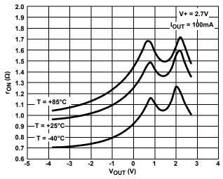
FIGURE 12. ON-RESISTANCE vs SWITCH VOLTAGE
