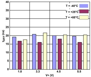
FIGURE 18. TURN-OFF TIME vs SUPPLY VOLTAGE
