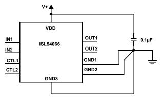
FIGURE 7. STAR GROUNDING CONFIGURATION
