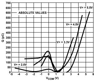
FIGURE 15. CHARGE INJECTION vs SWITCH VOLTAGE
