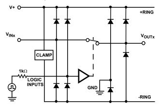
FIGURE 8. OVERVOLTAGE PROTECTION
