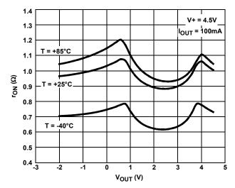
FIGURE 10. ON-RESISTANCE vs SWITCH VOLTAGE
