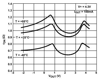
FIGURE 11. ON-RESISTANCE vs SWITCH VOLTAGE
