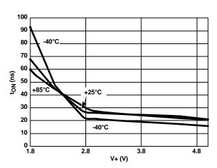
FIGURE 11. TURN-ON TIME vs SUPPLY VOLTAGE
