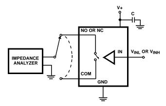
FIGURE 5. CAPACITANCE TEST CIRCUIT
