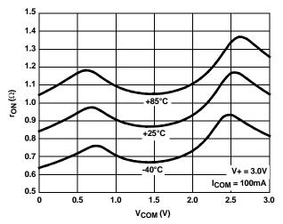
FIGURE 9. ON-RESISTANCE vs SWITCH VOLTAGE
