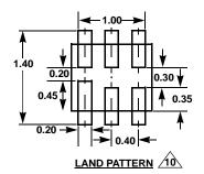
**L6.1.2x1.0A**6 LEAD ULTRA THIN DUAL FLAT NO-LEAD PLASTIC PACKAGE
