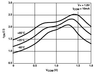
FIGURE 10. ON-RESISTANCE vs SWITCH VOLTAGE
