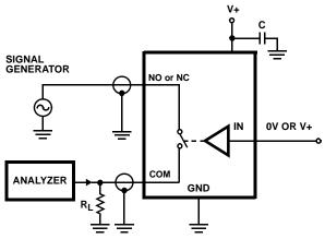
FIGURE 3. OFF ISOLATION TEST CIRCUIT
