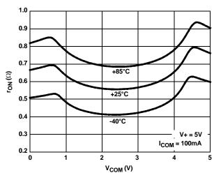
FIGURE 8. ON-RESISTANCE vs SWITCH VOLTAGE
