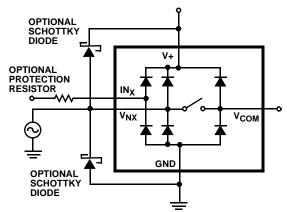
FIGURE 6. OVERVOLTAGE PROTECTION
