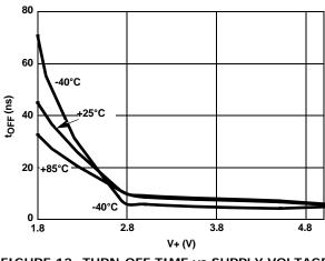
FIGURE 12. TURN-OFF TIME vs SUPPLY VOLTAGE
