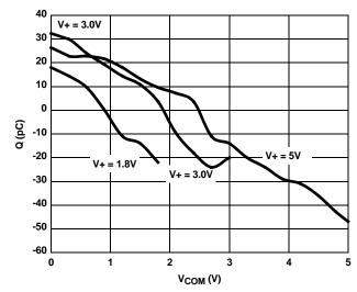
FIGURE 16. CHARGE INJECTION vs SWITCH VOLTAGE
