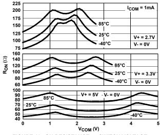
FIGURE 12. ON RESISTANCE vs SWITCH VOLTAGE
