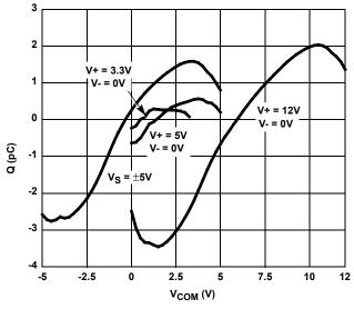
FIGURE 21. CHARGE INJECTION vs SWITCH VOLTAGE
