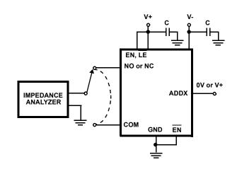
FIGURE 8. CAPACITANCE TEST CIRCUIT
