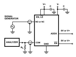
FIGURE 5. OFF ISOLATION TEST CIRCUIT
