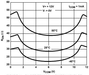
FIGURE 13. ON RESISTANCE vs SWITCH VOLTAGE
