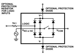
FIGURE 9. INPUT OVERVOLTAGE PROTECTION
