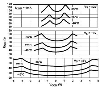
FIGURE 11. ON RESISTANCE vs SWITCH VOLTAGE
