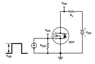
FIGURE 18. SWITCHING TIME TEST CIRCUIT
