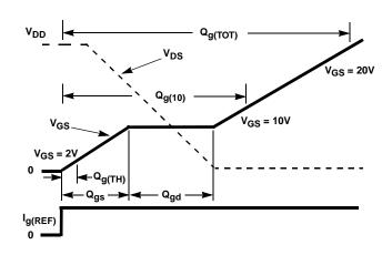
FIGURE 17. GATE CHARGE WAVEFORM
