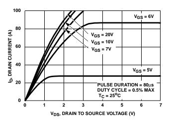
FIGURE 7. SATURATION CHARACTERISTICS
