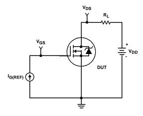
FIGURE 16. GATE CHARGE TEST CIRCUIT
