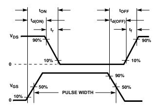
FIGURE 19. RESISTIVE SWITCHING WAVEFORMS
