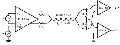
FIGURE 9. DUAL SIGNAL TRANSMISSION CIRCUIT
