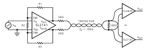
FIGURE 7. TYPICAL TWISTED PAIR APPLICATION
