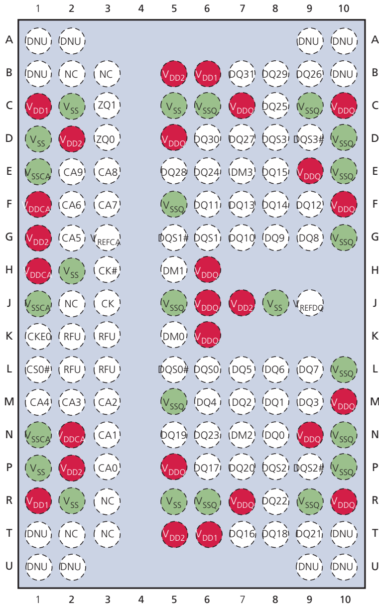
Figure 8: 134-Ball FBGA (32 Meg x 32, 64 Meg x 32)
