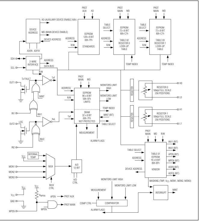
Figure 1. DS1858 Block Diagram
