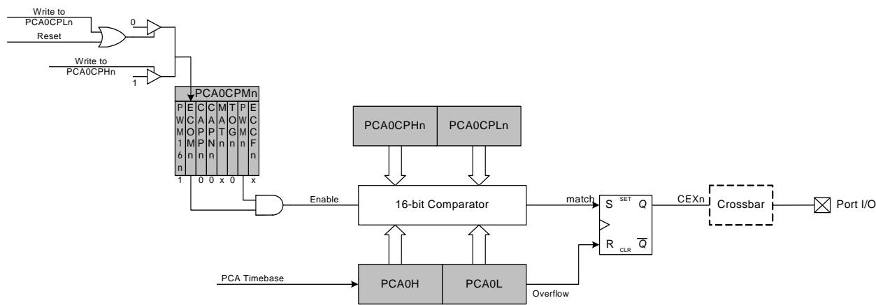
**Figure 33.10. PCA 16-Bit PWM Mode**
