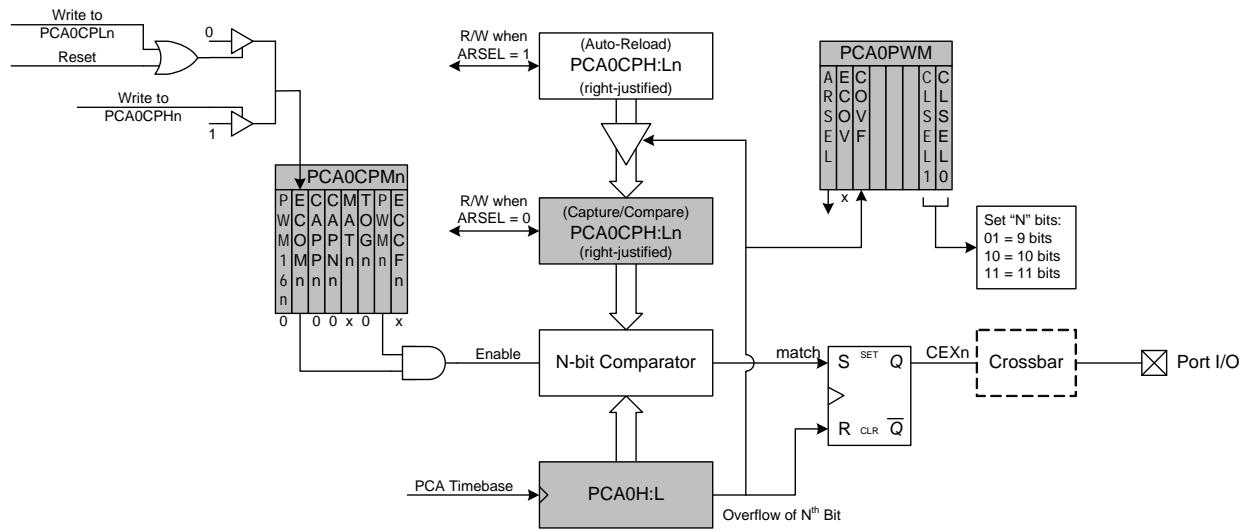
Figure 33.9. PCA 9, 10 and 11-Bit PWM Mode Diagram
