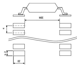
SOP8, SSOP-B8, SOP-J8, MSOP8 SOP14, SSOP-B14, SOP-J14
