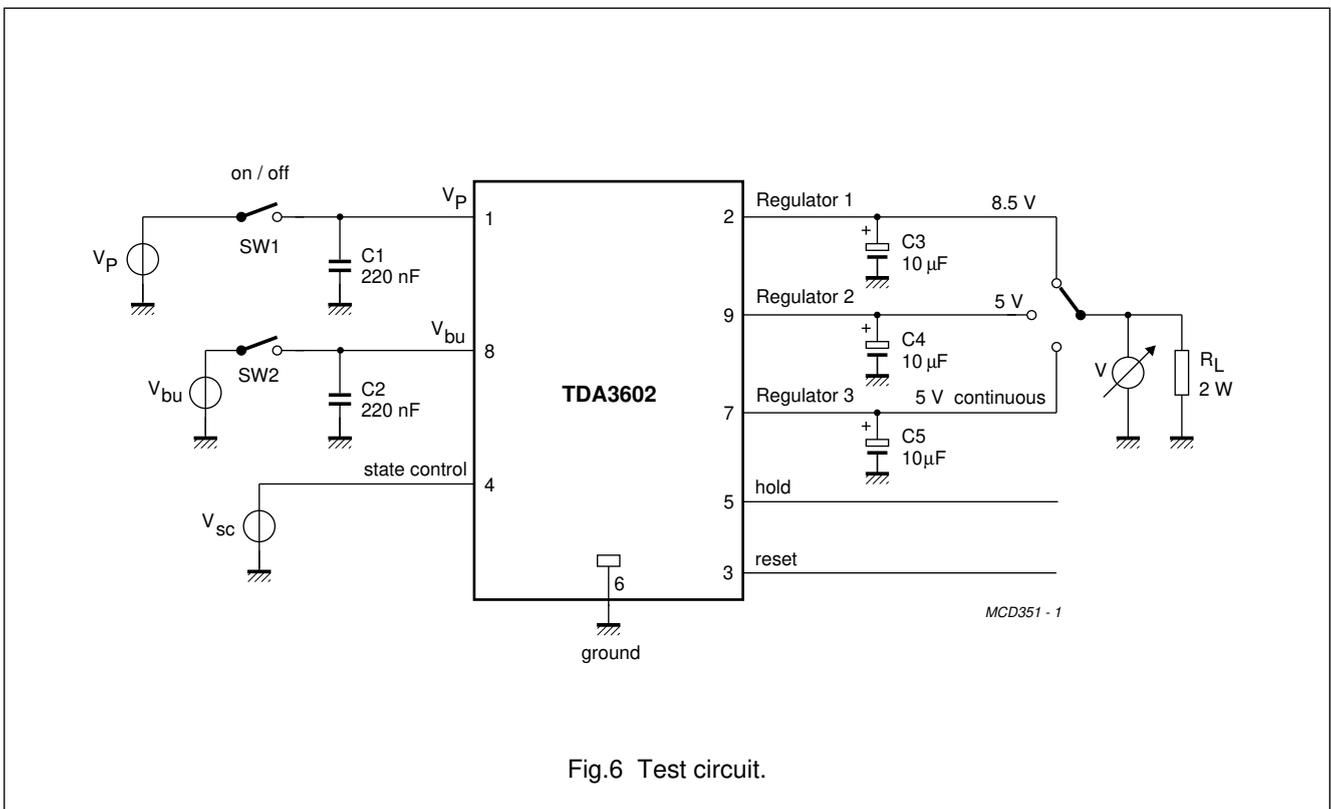
Fig.6 Test circuit.
