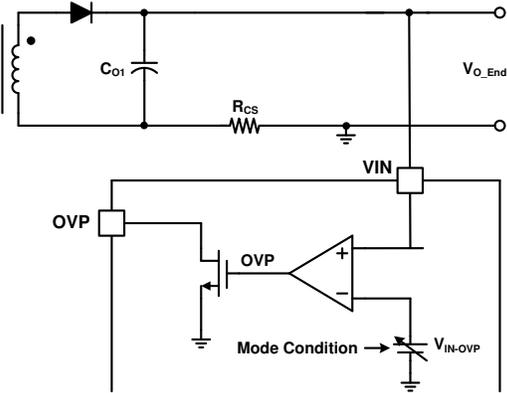
Figure 40. V<sub>IN</sub> Over-Voltage-Protection Block
