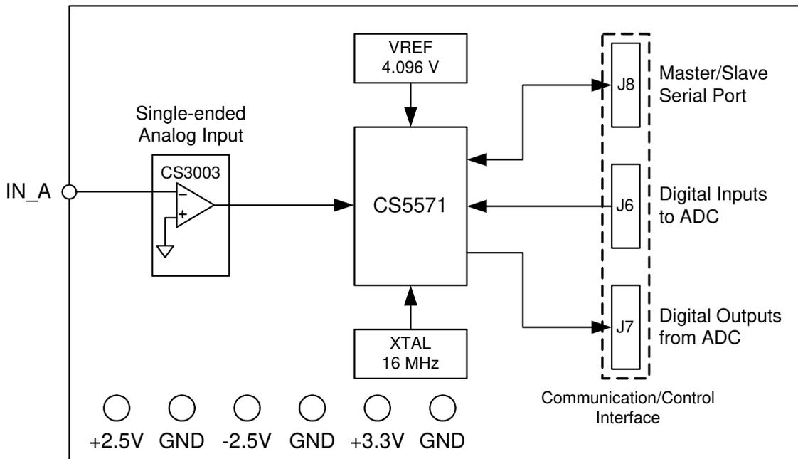
**Figure 1. CDB5571-2 Block Diagram**
